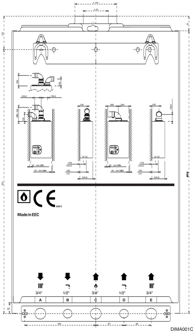
Posizionare la caldaia utilizzando l'apposita dima di carta stampata sull'imballo o in caldaia, impiegando una livella a bolla.
