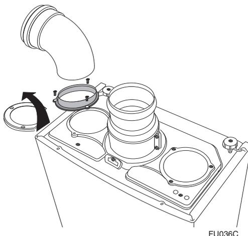
Si ha anche la possibilità di utilizzare un **scarico fumi con tubi sdoppiati**, impiegando uno speciale adattatore sul collettore di scarico e inserendo il tubo nella presa d'aria predisposta.
